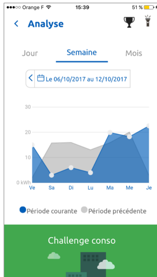
Analyse Consultation des index via les onglets « mois » et « semaine », et de la courbe de charge au pas 30 minutes via l'onglet « jour »
